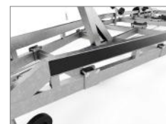
Förstärkt svetsat chassi
