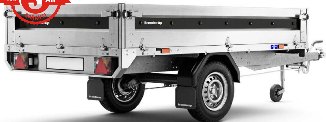
Flakytan skyddad av stålprofil
