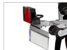
Separerad fast belysning
