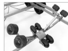
Förstärkt självjusterande vagger med kölrullar
