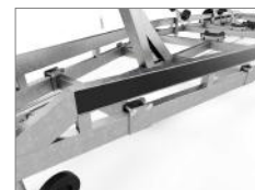
Förstärkt svetsat chassi
