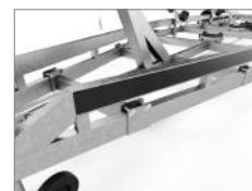
Förstärkt svetsat chassi
