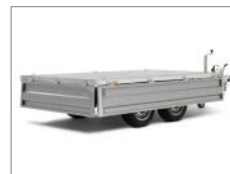
Fällbara och avtagbara lämsidor och hörnstolpar
